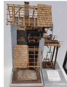
▲ Model novobanského atmosférického parného stroja na čerpanie banských vôd z bývalej šachty Althandel vystavený v Pohronskom múzeu v Novej Bani
