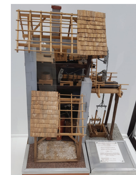
▲ Model novobanského atmosférického parného stroja na čerpanie banských vôd z bývalej šachty Althandel vystavený v Pohronskom muzeu v Novej Bani
